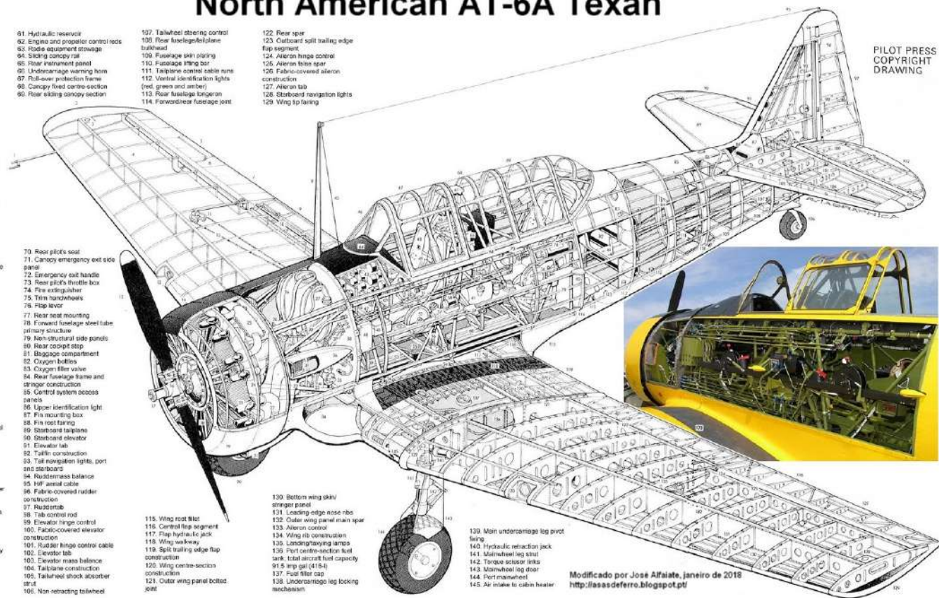
Esquema em corte do AT-6A - Fonte: asasdeferro.blogspot.com
